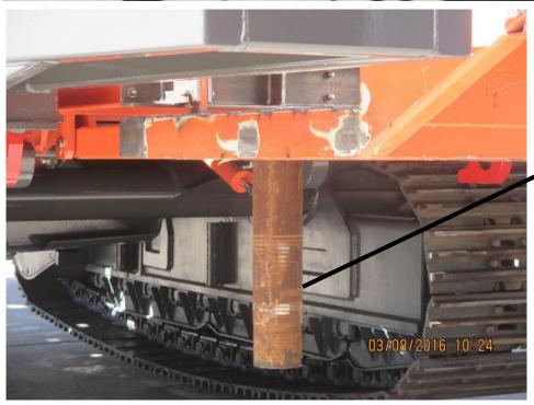
➤ LOWER THE DRILL PIPE APPROXIMATELY 200mm ABOVE GROUND LEVEL
